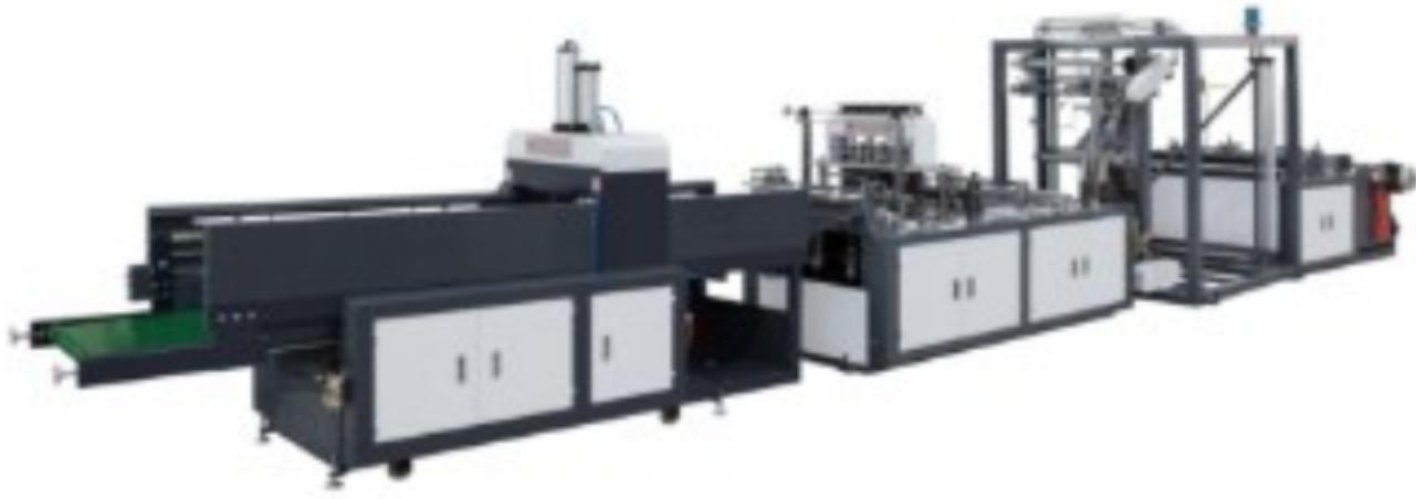
配以步进式定长，光电跟踪，准确，平稳。自动计数即可设定计数报警，自动打孔等工控装置，使其生产的成品封线牢固，切线美观。高效率，是您可以放心使用的质量环保型制袋设备。无纺布机械原理特点无纺布制袋机是由给料机定期送粉料（胶体或液体）到包装机上方的料斗器内，引进速度由光电定位装置控制，成卷的封口纸（或其它包装材料）经导辊带动引进至翻领成型器，被折弯后再由纵封器搭接成为圆筒状，物料被自动计量后充填到制成的袋内，横封器在进行热封切割的同时将袋筒间歇地向下牵引，形成搭接纵缝三面封口扁平袋，完成一个袋的封口。
