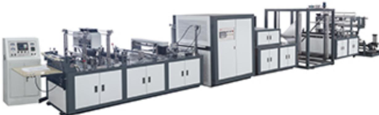
全自动无纺布制袋机特点设计工艺先进,生产速度快,效率高,能加工不同规格、不同形状的环保无纺布袋,具有质量好、黏合强度高等特点。无纺布制袋机应用1. 无纺布袋压边: 压合无纺布袋的边缘; 2. 无纺布袋压花: 无纺布袋上端和边缘的花纹压合; 3. 无纺布手挽带压合: 通过套筒自动压合手挽袋。机器特点1. 利用超声波焊接,免用针线,省去频繁换针线的麻烦,没有传统线缝合的断线接头情况,还可对纺织品进行整洁的局部剪切与密封。缝合的同时也起到了装饰的作用,粘固力强,可达到防水效果,压纹清晰,表面更加具有立体浮雕效果,工作速度快,产品效果好更显高大上美观;品质有保证。安徽无纺布拉链制袋机厂家瑞安市鑫达包装机械有限公司致力于提供无纺布制袋机,有需求可以来电咨询!
