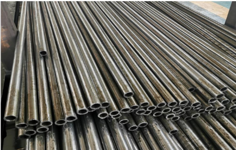
城市由于工业好和人们日常生活都会产生比较多的污水。这些污水都会经过城市里的排污管道来进行处理。环境治理工程建设中,排污系统常占有较大的投资比例。排污系统中所用的管道并不是普通的钢管,而是合金管,因为只有合金管才能满足排污系统的要求。合金管的抗腐蚀性能非常好,因为合金管在加工环节还会对其进行耐腐蚀性能的检测处理。就是把管道放进酸性溶液中进行性能检测。这样来就能满足污水中的酸性或者碱性物质的排放。进而保证了城市排水系统的安全和城市各个方面的正常运行下意识里都会觉得合金管沉甸甸的特别沉重。可是
